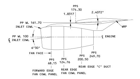
LEFT SIDE VIEW OF NACELLE FOR ROLLS ROYCE RB211-535E4 ENGINE
