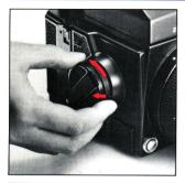
A. カメラメインボディの巻き 上げクランクをはずします。巻 上げクランク座にある取りはず しレバーを外側にスライドしな がら、クランク座を左に回しま すと、クランク座がはずれます。 ※クランク座をはずしましたら 防塵のため、附属のカバーをか ぶせておきます。
