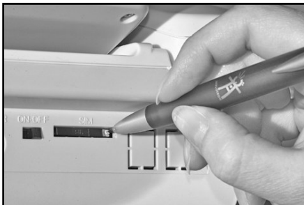
1. ábra: SIM kártya tartó kiemelése
