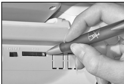
Рисунок 1: Извлечение держателя для SIM-карты
