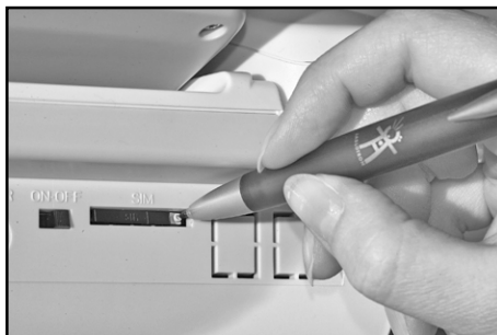
Joonis 1: SIM-kaardi hoidiku eemaldamine
