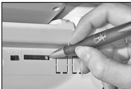
Slika 1: Odstranjevanje ležišča SIM kartice
