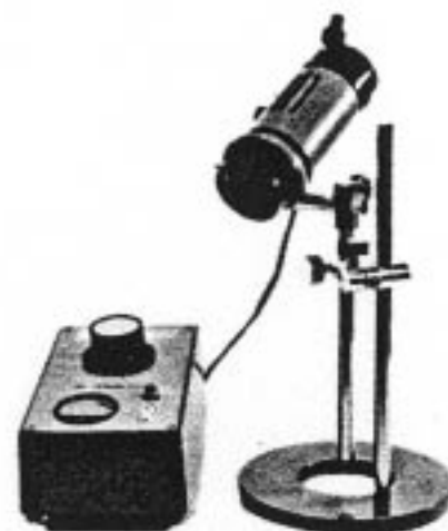
■PM-LSD2落射照明装置 ……………¥50,000 マクロフォトには欠かせない2個で1組の落射照明装置です。斜光落射照明として直接使うこともできますし、PM-ELを併用すれば垂直落射照明にも使えます。フィラメントを前後に移動させて、焦点を変え、照明光束の巾を広げたり狭めたりできます。トランスとしてLSDと同じものが2個と、照明用フィルターが8種付いています。
