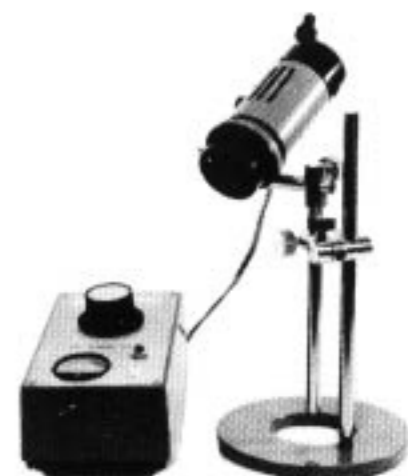
■PM-LSD2落射照明装置……………¥50,000 マクロフォトには欠かせない2個で1組の落射照明装置です。斜光落射照明として直接使うこともできますし、PM-ELを併用すれば垂直落射照明にも使えます。フィラメントを前後に移動させて、焦点を変え、照明光束の巾を拡げたり狭めたりできます。トランスとしてLSDと同じものが2個と、照明用フィルターが8種付いています。
