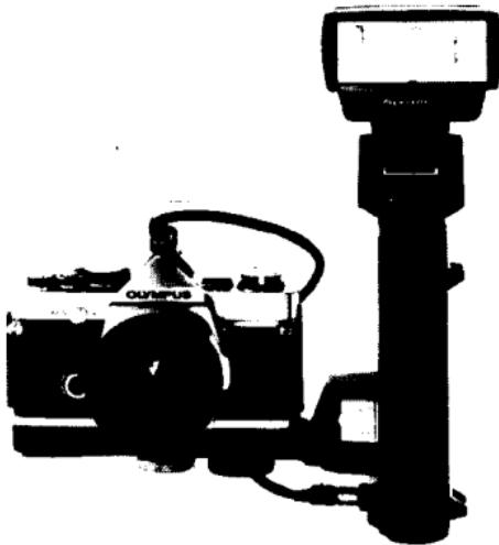
Ein TTL-Autocord T wird zwischen das Blitzgerät "T 32" oder "T 20" und eine OM-2N (oder OM-2/OM-1N) geschaltet, auf der ein TTL Auto Connector befestigt ist.
