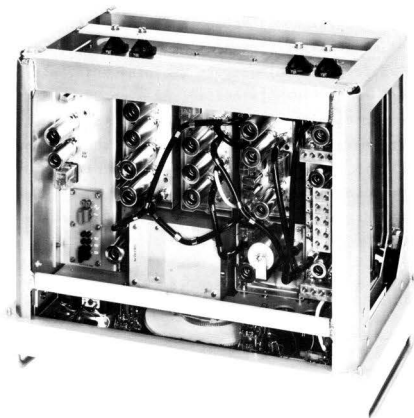
Bild 4 Empfänger-Einschub ohne und mit Schwingrahmen FIG. 4 RECEIVER SLIDE-IN CHASSIS WITHOUT AND WITH SHOCK-MOUNTING FRAME
