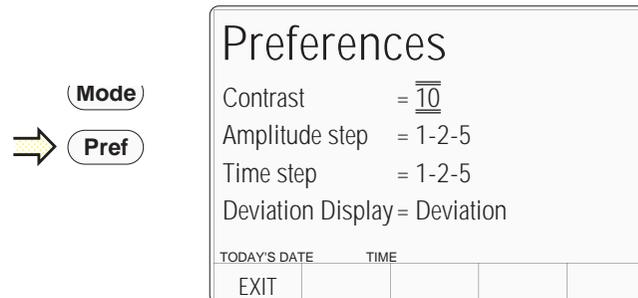
Fig. 3.3.2 'Pref' Parameters
