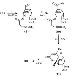
Scheme 2. i,  $TiCl_4$ ,  $CH_2Br_2$ , Zn; ii,  $Hg(OAc)_2$ ,  $Me_2CO-H_2O$  then  $H_2CrO_4$ ; iii, NaH, THF, heat; iv,  $H_2$ , PtO<sub>2</sub>, MeOH.
