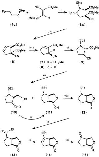
Scheme 1. Reagents and conditions: i,  $CH_2Cl_2$ , room temp.; ii, HCl,  $CH_2Cl_2$ ; iii, *hv*,  $CCl_4$ ; iv, NaOMe, MeOH, room temp.; v, LiI, DMF, reflux; vi, LiSEt, tetrahydrofuran, -70 °C; vii,  $Bui_2AlH$  (3.3 equiv.),  $Et_2O$ , -20 to 0 °C; viii,  $Ag_2CO_3$  on Celite, benzene, reflux; ix, *mCPBA* (1.1 equiv.),  $CH_2Cl_2$ , 0 °C; x,  $(CF_3CO)_2O$ ,  $CH_2Cl_2$ , room temp.; xi,  $HgCl_2$ ,  $MeCN-H_2O$  (3:1), reflux.
