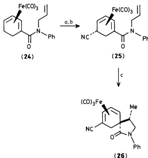
Scheme 6. Reagents: a,  $Ph_3C^+PF_6^-$ ,  $CH_2Cl_2$ , room temp., 3 h; b,  $NaCN$ ,  $MeCN$ , room temp., 16 h; c,  $Bu_2O$ ,  $CO$  atm., reflux, 6 h.
