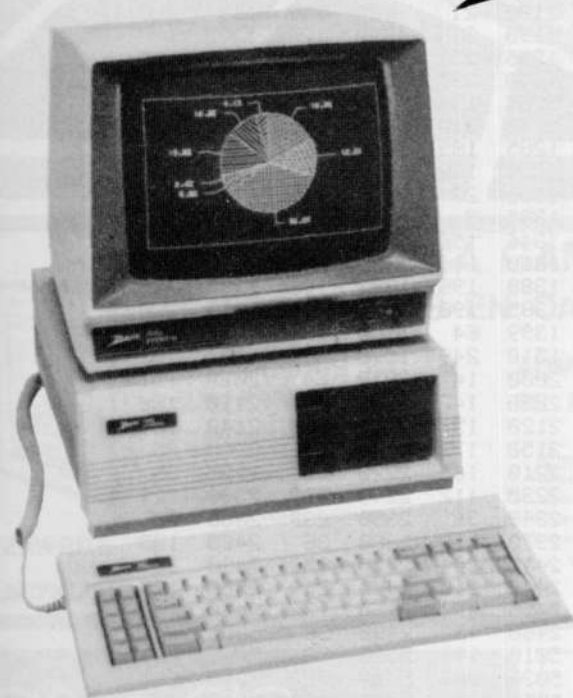
Z-150PC. 320 K, RAM, 2 Drives ampliables a 30 Mbytes, tarjeta de color, alta resolución compatible con IBM.
