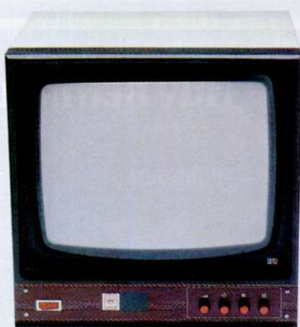
Monitor 14" Color para ordenador personal, especial para Commodore, Dragón, QL, etc. Señal compuesta y RGB.
