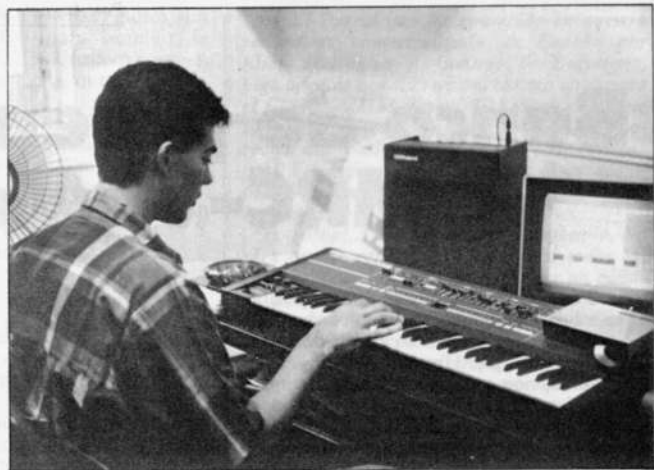
El Sintetizador JUNO-60 conectado al C-64 mediante el Midi.
