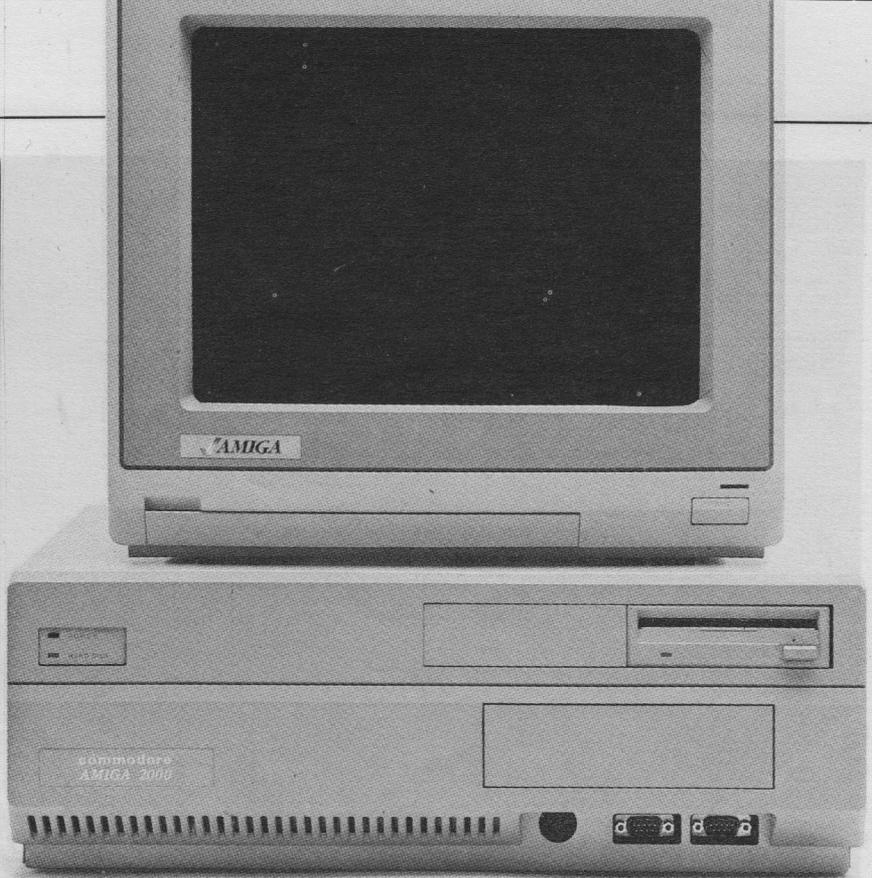
floppys de 5 1/4, 512 Kbytes de RAM y un zócalo para coprocesador aritmético 8087. Además, incluye un chip encargado de emular muchas de las tareas de un PC/XT, como control de interrupciones y de temporización.
