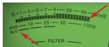
Bild 9: So muss es sein; die Maximalleistung geht eine Winzigkeit zurück und die ALC spricht nicht mehr an. Foto: DL2RD
