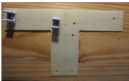
**Bild 10:** GFK-Platte mit zwei Klemmschellen
