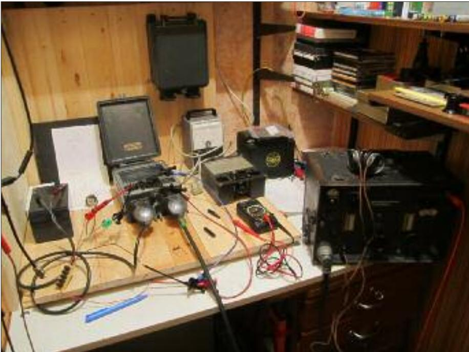
**Versuchsaufbau zum Test des elektron. „Zerhackers“**
