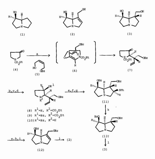
a) TSOH (cat.),  $Na_2SO_4$ , xylene, reflux b)  $NaBH_4$ , MeOH, 0°C c) NaH, BZBr, THF, reflux d) KOH, diethylene glycol, reflux e) HCl,  $Et_2O$ , MeOH f) PhSCl,  $CH_2Cl_2$ , 0°C g)  $K_2CO_3$ , NaI, MeCN, reflux h) m-CPBA,  $CH_2Cl_2$ , - 20°C i) xylene, reflux j) Li, liq. NH<sub>3</sub>, THF, - 33°C k) Raney nickel, EtOH, reflux 1) H<sub>2</sub>, PdCl<sub>2</sub>, MeOH-CHCl<sub>3</sub>, room temp.
