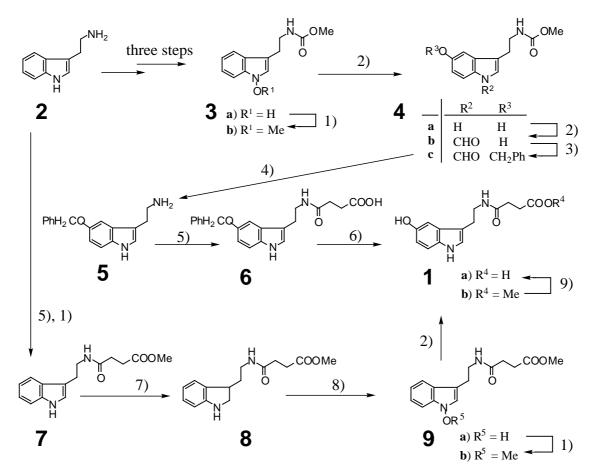
1) CH<sub>2</sub>N<sub>2</sub>; 2) 85% HCOOH; 3) PhCH<sub>2</sub>Br, K<sub>2</sub>CO<sub>3</sub>, DMF; 4) 10% NaOH, MeOH; 5) succinic anhydride, THF; 6) 10% Pd/C, H<sub>2</sub>; 7) Et<sub>3</sub>SiH, CF<sub>3</sub>COOH; 8) Na<sub>2</sub>WO<sub>4</sub>·2H<sub>2</sub>O, 30% H<sub>2</sub>O<sub>2</sub>; 9)1<sub>M</sub> K<sub>2</sub>CO<sub>3</sub>, MeOH.
