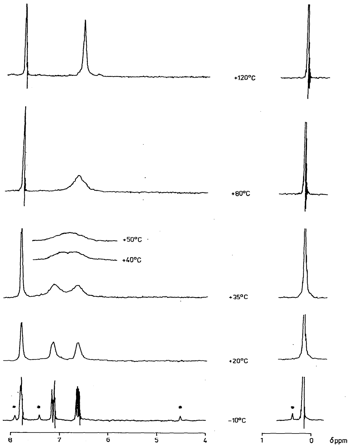
Abb. 5: Temperaturabhängiges ^1\text{H-NMR} -Spektrum von Bis(trimethylsilyl)cyclopentadienyl-dibromboran VIII
