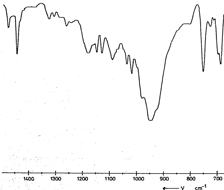
(c) IR-Spektrum von (\text{PhSO}_2)_3\text{SnMn}(\text{CO})_5 (fest, KBr)
