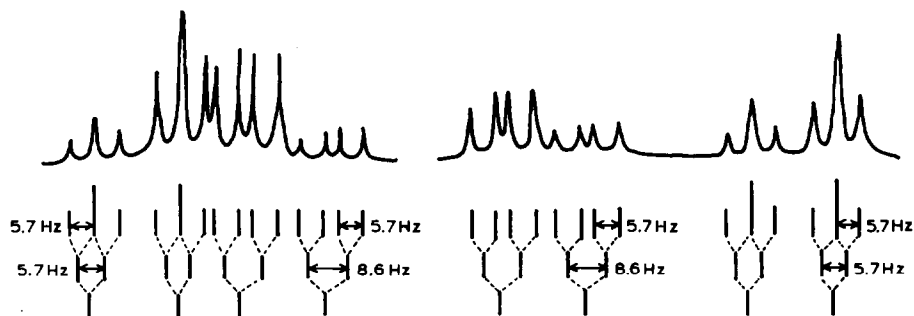
Fig. 1. Ausschnitt aus dem ^1\text{H-NMR} -Spektrum von \text{C}_5\text{Me}_5(\text{CO})(\text{CF}_3\text{COO})_2\overline{\text{W}}[\eta^2\text{-C}(\text{O})\text{CH}_2\text{CH}_2\text{COMe}] (II): Zwei ABXY-Aufspaltungsmuster unterschiedlicher Intensität der zwei \text{CH}_2 -Gruppen in den Isomeren IIa und IIb.
