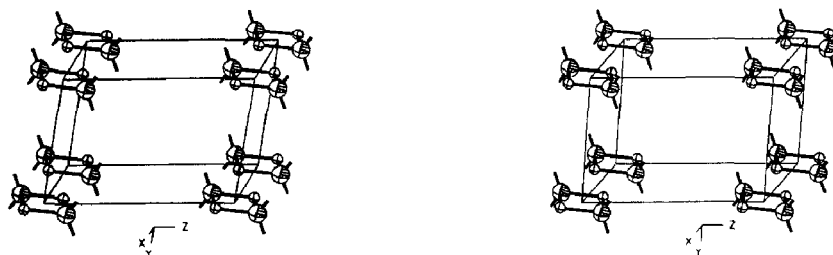
Fig. 3. Anordnung der Sn-S-Vierringe im Kristallgitter von \beta -(t-Bu 2 SnS) 2 (Stereobild).
