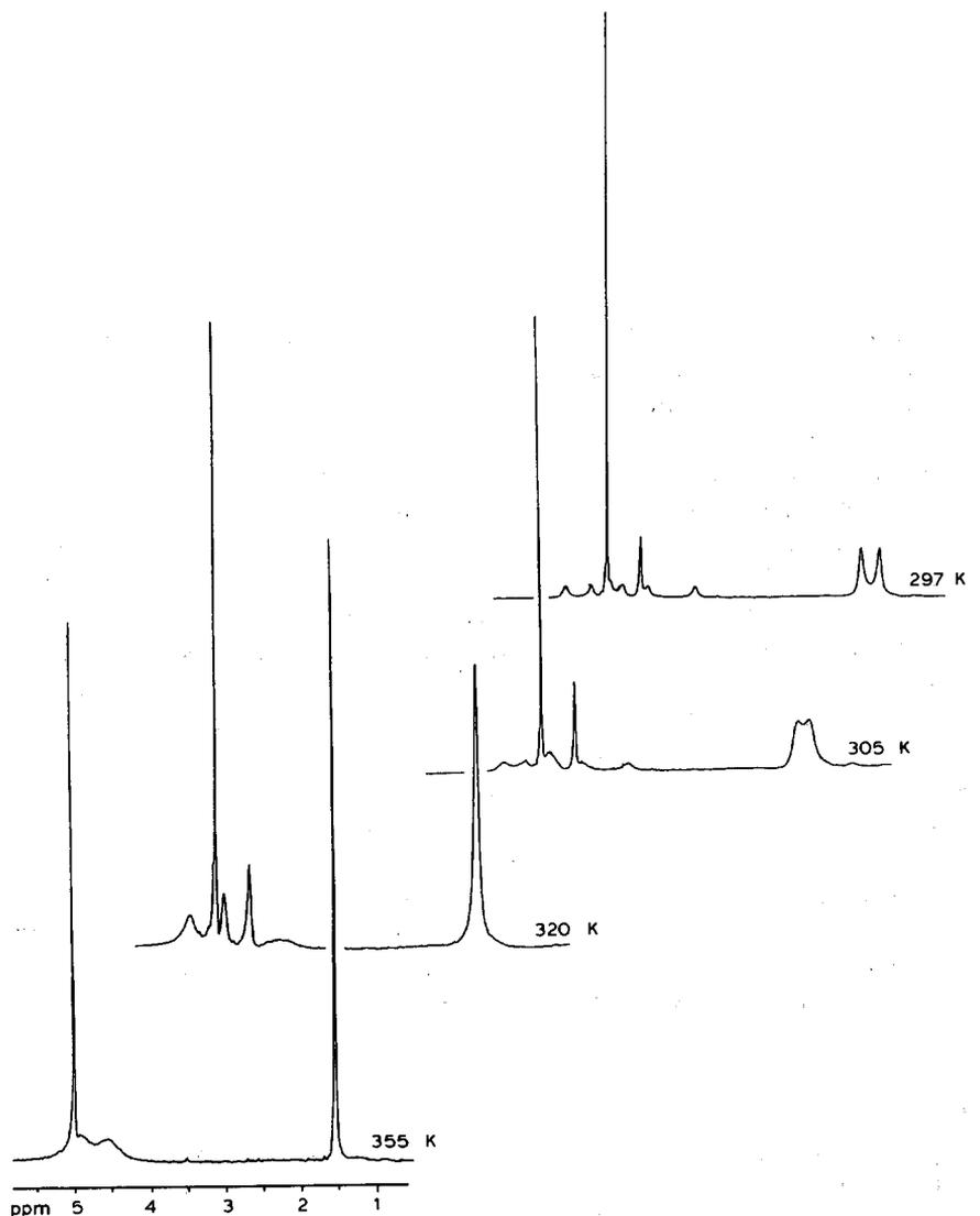
Fig. 1. Spectre RMN  $^1\text{H}$  du complexe  $(\text{C}_5\text{H}_4\text{Me})_2\text{NbW}(\text{Cp})(\text{CO})_3$  (**5a**) ( $\text{C}_6\text{D}_6$ ): évolution en fonction de la température.
