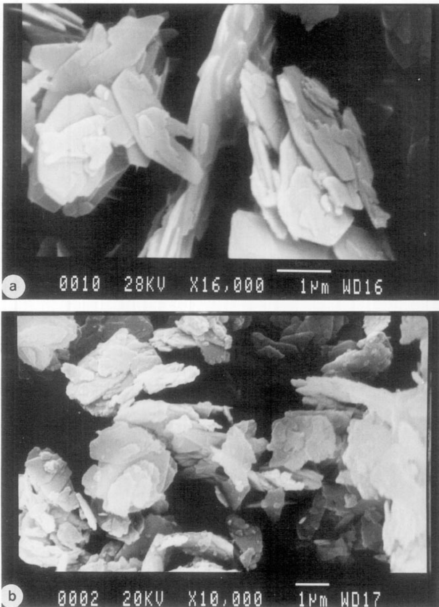
FIG. 1. SEM micrographs of (a) \text{VO}(\text{HPO}_4) \cdot 0.5\text{H}_2\text{O} , (b) \text{LiVOPO}_4 \cdot 0.5\text{H}_2\text{O} .
