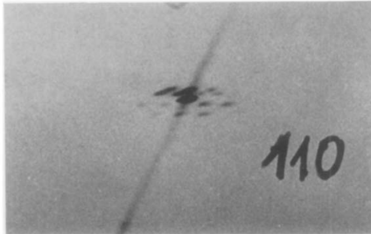
ABB. 9. Ausschnitt aus Weissenbergaufnahme um [001], Äquator, eines Kristalls wie in Abb. 8, jedoch bei 1200°C 1^4 nachgetempert. Chromreiche Randzone mit Satellitenreflexen der ausgeschiedenen Andersson-Phasen.
