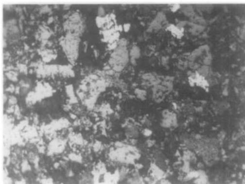
FIG. 2. Précipités intergranulaires d'argent à la cathode après expérience de transport dans une cellule +Ag/LaOAgS/Pt-.  $\times 180$ .
