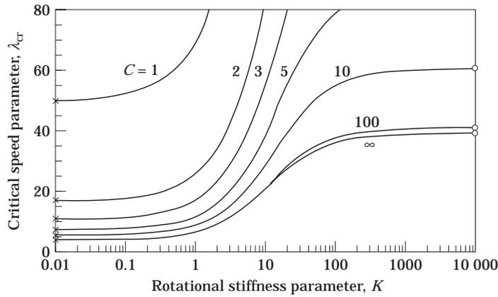
Figure 3. The critical speed parameter  $\lambda_{cr}$ .  $\times$ ,  $K = 0$ ;  $\circ$ ,  $K = \infty$ .
