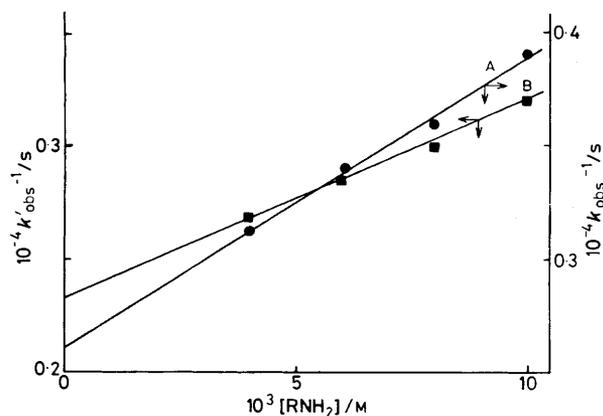
**Figure 5.** Dependence of  $k_{\text{obs}}$  on  $[\text{RNH}_2]$ ; A,  $k_{\text{obs}}^{-1}$  versus  $[\text{RNH}_2]$ ; B,  $k'_{\text{obs}}^{-1}$  versus  $[\text{RNH}_2]$ .  $[\text{Cl}^-]$  0.015;  $[\text{CAT}]$   $4.7 \times 10^{-3}$ ;  $[\text{AA}]$  0.04;  $[\text{H}^+]$  0.10;  $\mu$  0.14M;  $t$  30 °C
