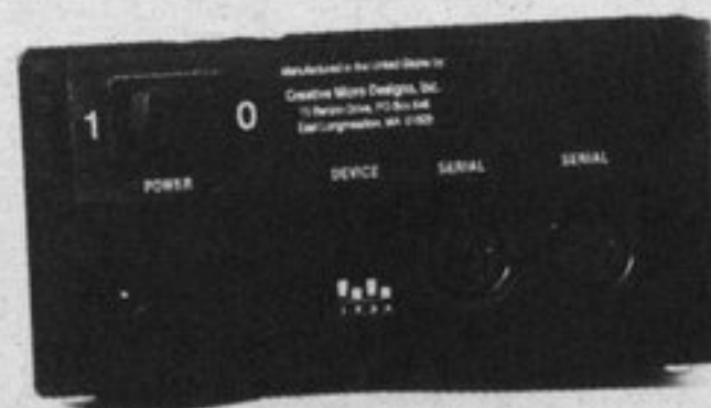
Die Rückseite der FD-2000 zeigt keine Besonderheiten. Serielle Anschlüsse, DIP-Schalter für die Geräteadresse und Ein-/Aus-Schalter.
