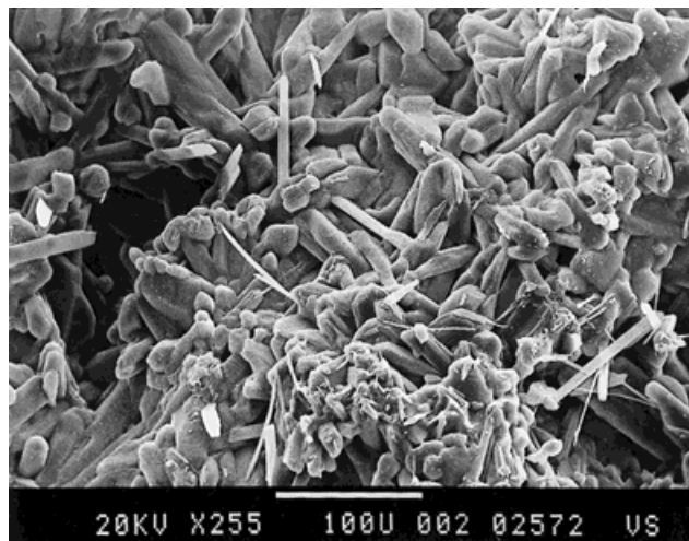
Abb. 1: REM-Aufnahme von thermisch belastetem schockagglomeriertem S(+)-Ibuprofen, 250fache Vergrößerung (Charge S 1)
