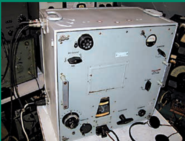
Reparatieverslag van een Duitse rechtuit ontvanger LO6K39a
