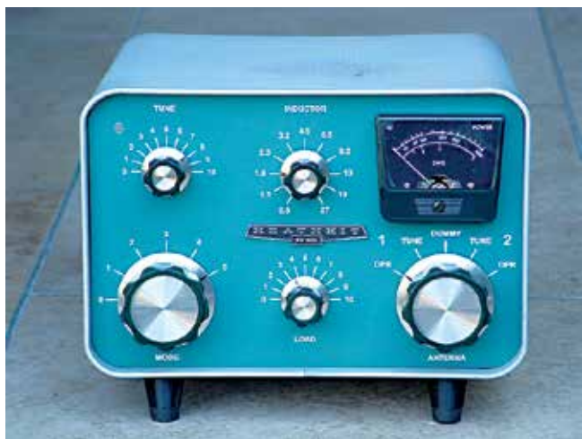
In kleur, met bedrukking. Dit zou zó uit de fabriek kunnen komen. Er kan gekozen worden voor twee antennes of de dummy load. De antennes hebben beide een stand Tune en een stand Operate. (2020)
