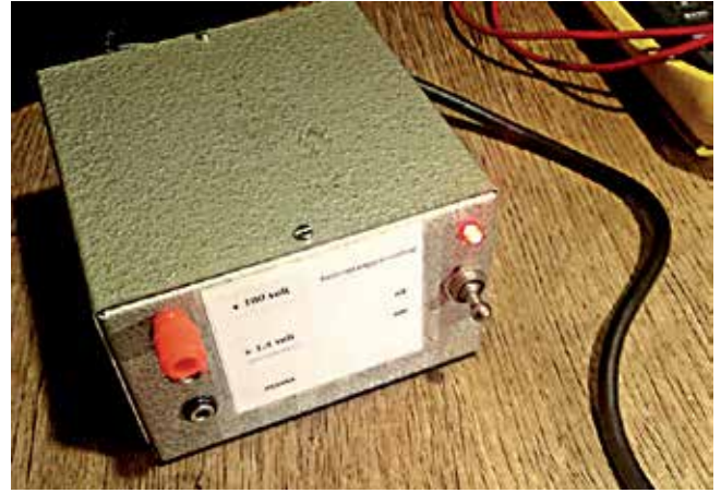
Foto 5: De voeding in haar kastje, handzaam en zonder herrie. De aan/uit schakelaar komt uit een BC312.
