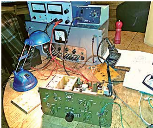
Foto 1: De originele voeding bleek niet alleen veel herrie, maar ook te veel gloeispanning te maken. Daarom tijdens de reparatie gebruik gemaakt van losse labvoedingen.
