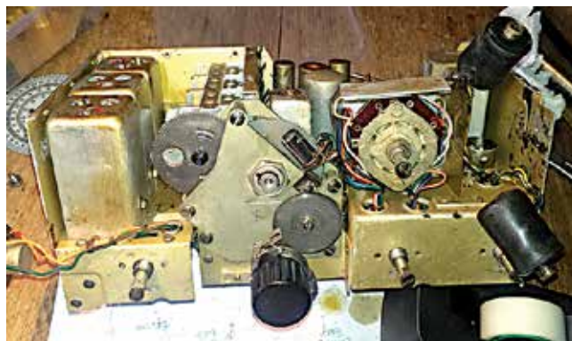
Foto 2: Schoonmaken en vastdraaien van schroefjes van de vertraging, de spanveer weer op spanning brengen. Een rustig werkje, te doen met overleg. Heel de frontplaat moest er af, spannend, maar viel achteraf reuze mee.
