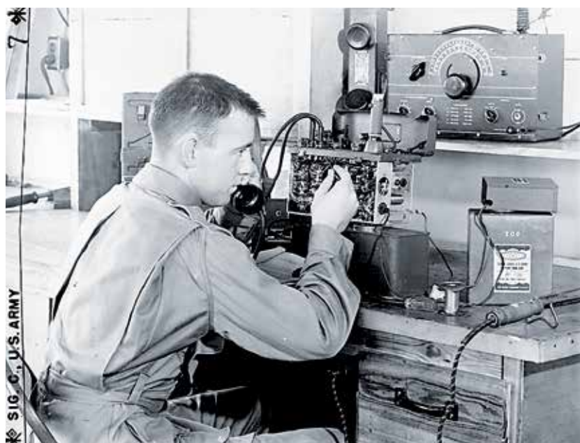
Privat Frank Obrien werkt in de radiowerkplaats van Fort Benning aan een "Back-Pack" BC-1000 als onderdeel van de groep SCR-300 US Army Signal Corps. Hij staat hier op zijn BA-70 batterij en bovenop de RayOVac batterij staat de Aligment Indicator I-210 (met het kattenog)
