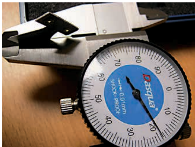
Foto 5 De dikte van het ankerplaatje 0,186 mm
