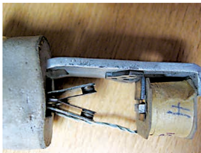
Foto 7 De trillercontacten van de asynchrone triller, ertussen normaal het trilcontact dat de losse contacten ongeveer 1mm meeneemt. Met het spoeltje een kunstig mechanisch goed afgestemd geheel.
