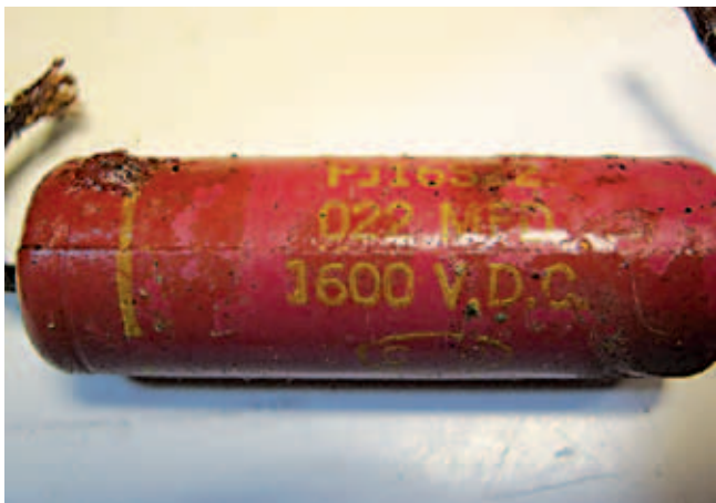
Foto 4: Defecte hsp condensator uit trillervoeding, Ondanks de "hermetische" afsluiting is er toch isolerende olie/dielectricum uitgelekt
