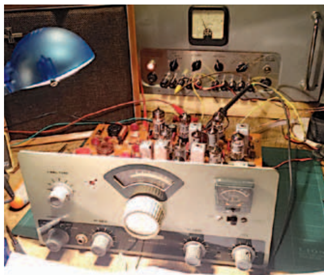
Foto 4: Het testen van de ontvanger van de HW12
