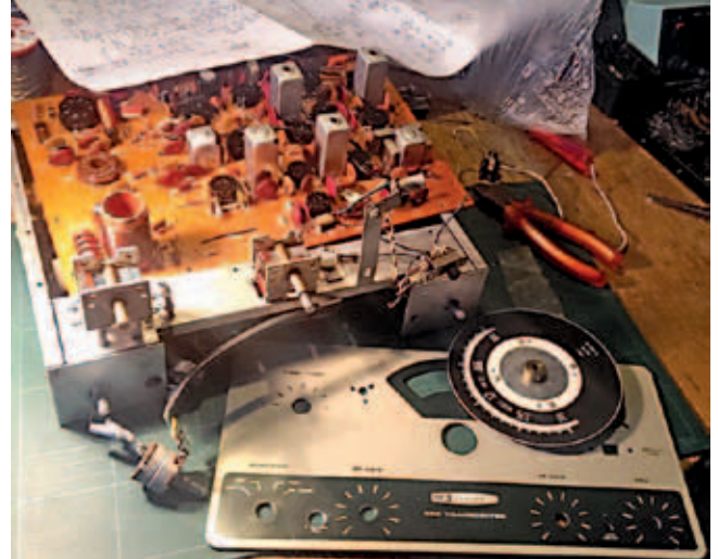
Foto 3: De HW12 flink uit elkaar: chassis, printplaat en frontplaat zijn net met wasmachinezeep gewassen, goed gespoeld met water en in een heteluchtoven bij 50°C gedroogd.
