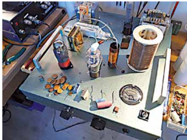
Foto 5 Het prototype met TL-smoorspoel
