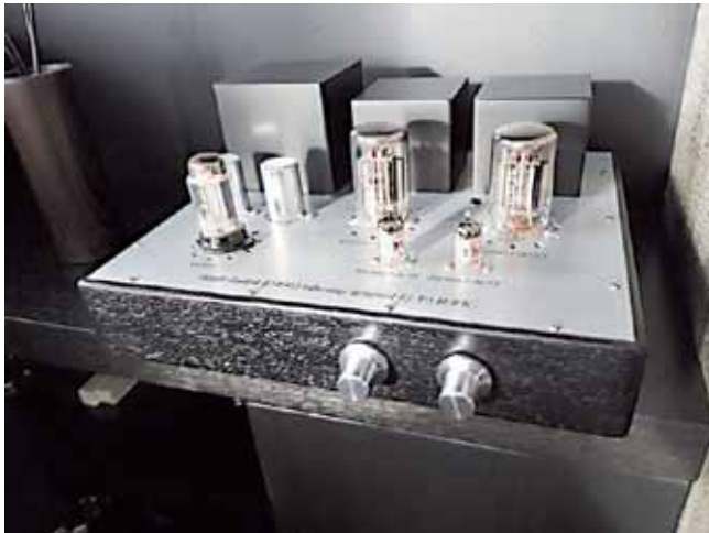
Foto 1 De Single Ended met Telefunken RS1003 buizen
