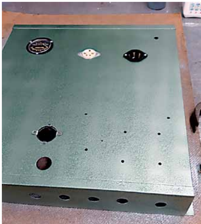
Foto 3 Het in hamerslag gespoten chassis
