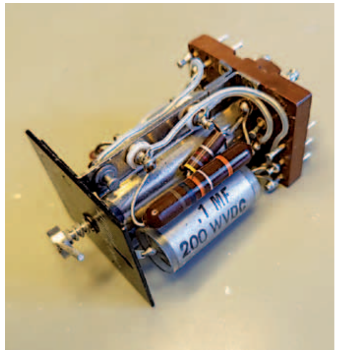
10. Componenten welke mogelijk een defect kunnen veroorzaken zijn zo ook eenvoudig eerste lijns te vervangen.
