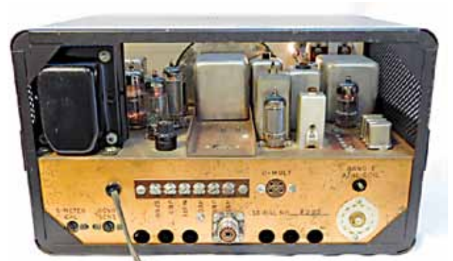
Foto 15 Als je achter in de 2B kijkt, zie je een behoorlijk compacte en gevulde ontvanger. De lege plaats die je ziet is voor de optionele kristalkalibrator of 160m convertor. En dan kan er echt niks meer bij...
