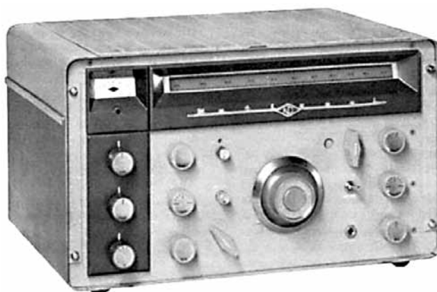
Foto 12 De National NC300, ook groot en mooi om te zien. En ook stabiliteitsproblemen, zij het niet zo erg als bij de HQ170.
