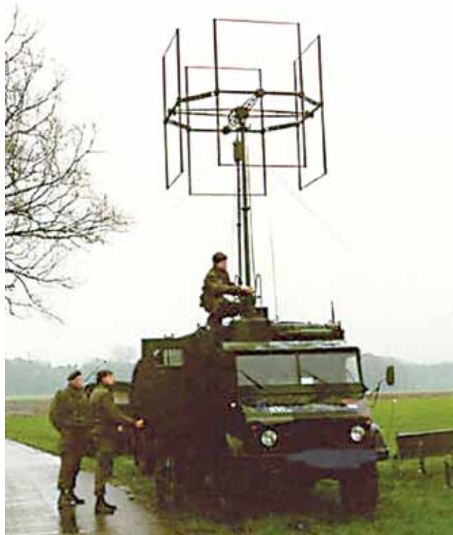
Een Hadcock-antenne systeem, in een Clark 30' mast, vast gemonteerd in de "Koffer" en mogelijkheid om de cabine te stempelen. Een aanhanger met aggregaat en VHF-radio completeerden destijds het geheel.
