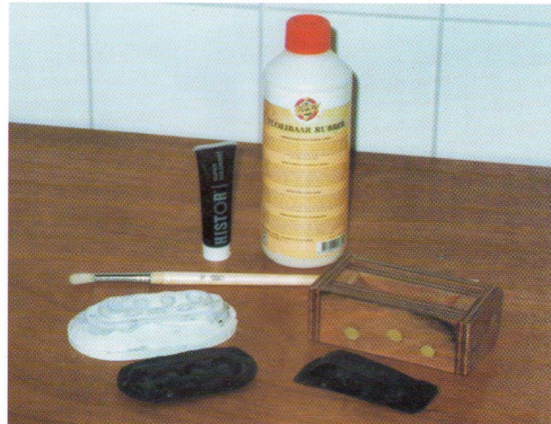
Foto 1 Houten mal met vloeibaar rubber
