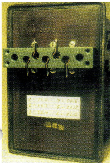
foto 2: PRC-26 met kunststof blok en contactbussen.
