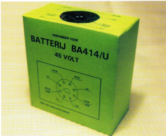
Foto 7: Zelfs een batterij voor de AN/GRA-6 (ABA) is te maken met zo'n omvormertje. De condensatortjes zijn zó gekozen dat na het loslaten van de spreekleutel deze snel leeglopen, hierdoor kan de oscillator snel reageren op een volgende actie.
