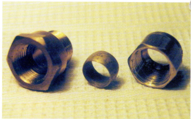
Knelkoppeling bestaande uit drie onderdelen, de knelring wordt vervangen door BNC moer (foto H. Dekker PEIECO)
