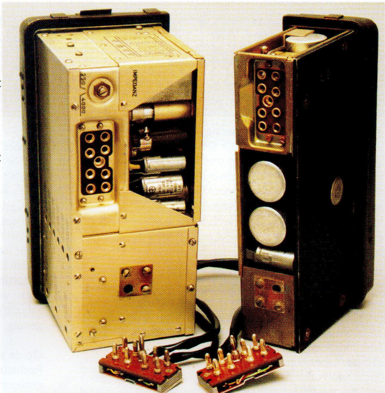
Foto 3 R-77 en PP-77 (rechts) na verwijdering van de behuizing
