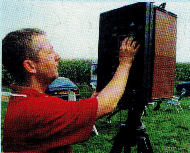
Eerst de onderlinge communicatie regelen: "Richtverbindungsgeraet" 7,7 - 8 GHz
