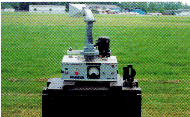
• 10 GHz ontvanger met klystron en draibare hoorn antenne
