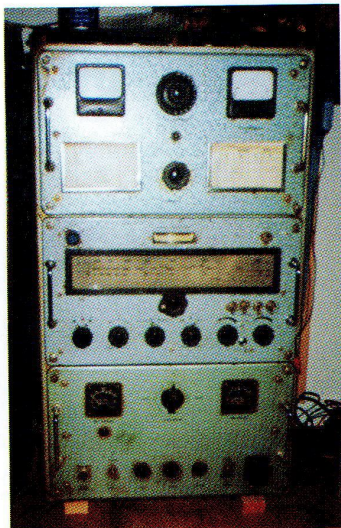
• Radio Holland 'Zeewolf', ± 1960 100 watt AM Philips PE1/100 eindtrap 2x EL 50 modulator
