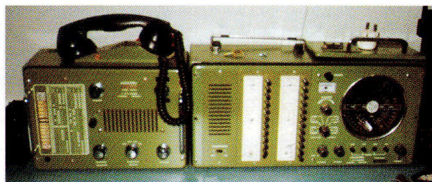
• Links de sailer marifoon type RT-142; rechts de sailer R-105 ontvanger 23 x-tal kanalen 2182 + mw/lw/sw
