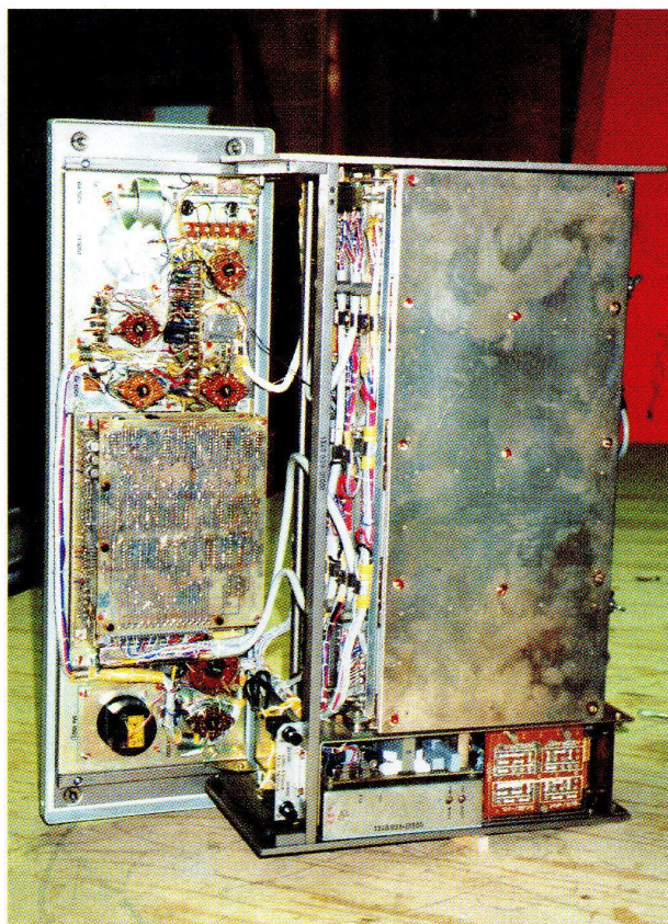
* Aanzicht van de EKD-315 met omgeklapt frontpaneel. Het printblok op het voorpaneel bevat de display unit en de pulsgever. Bovenaan is het kleine luidsprekertje te zien (in witte hoes) en onderaan het multifunctionele metertje
